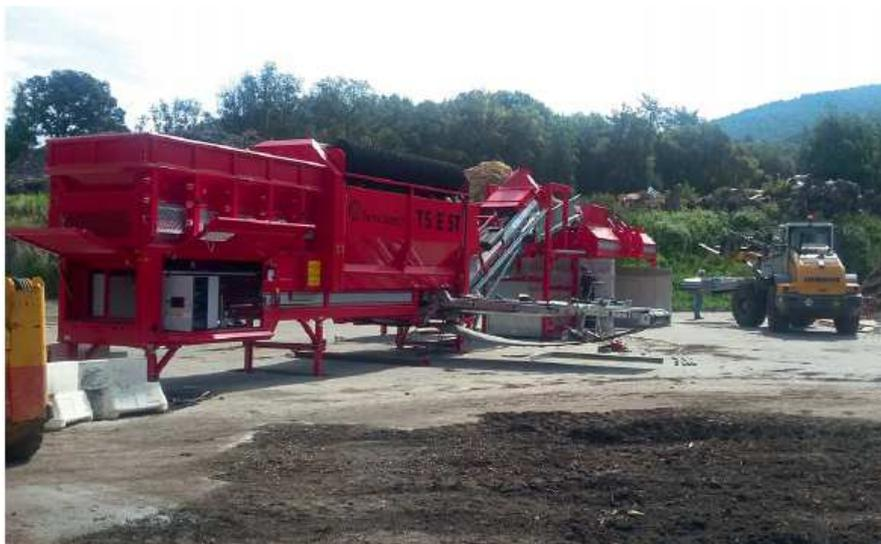
Appareil de criblage qui permet le passage du déchet vert broyé à l'état de compost
