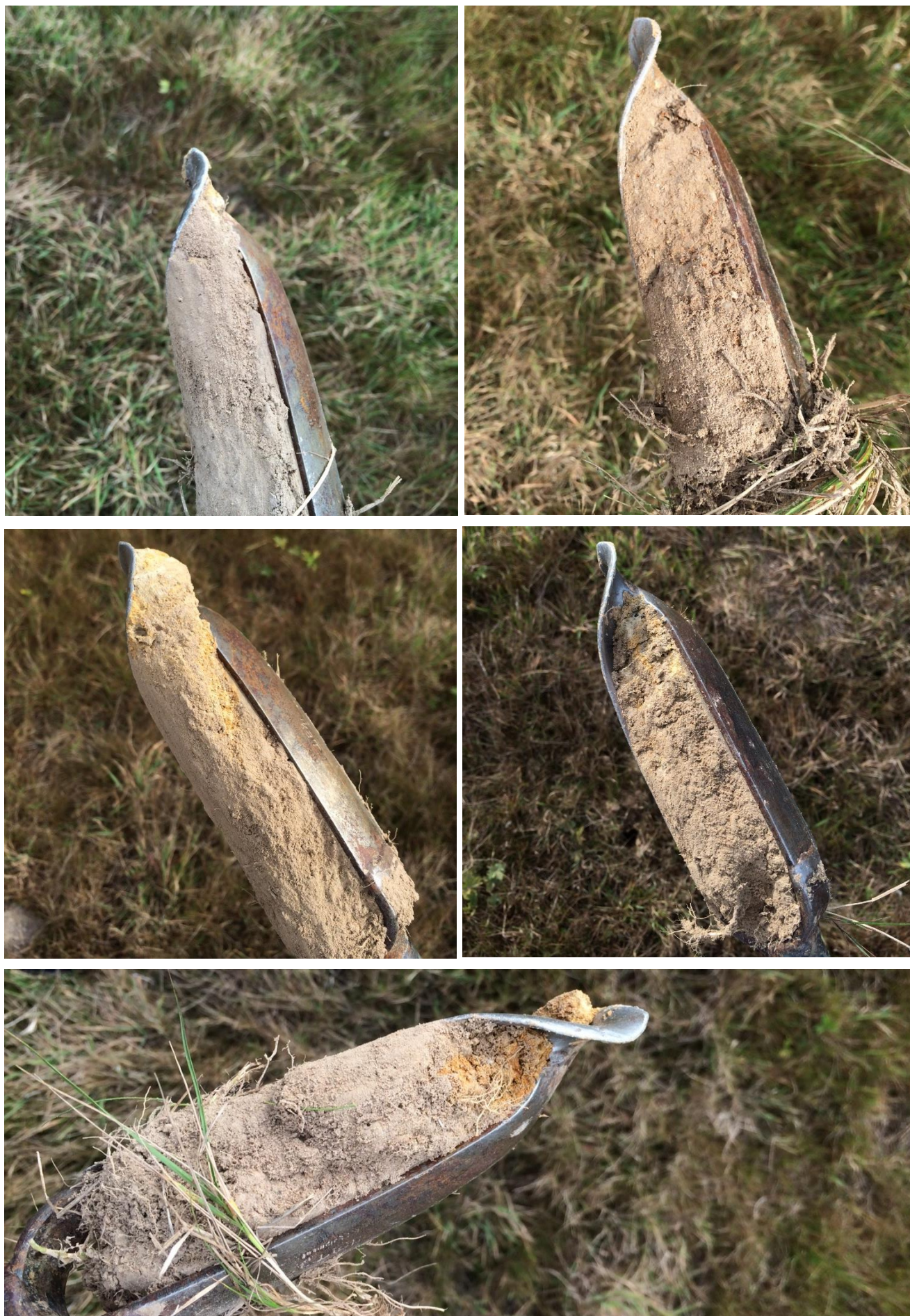
Figure 5 : vues de carottages sur site
